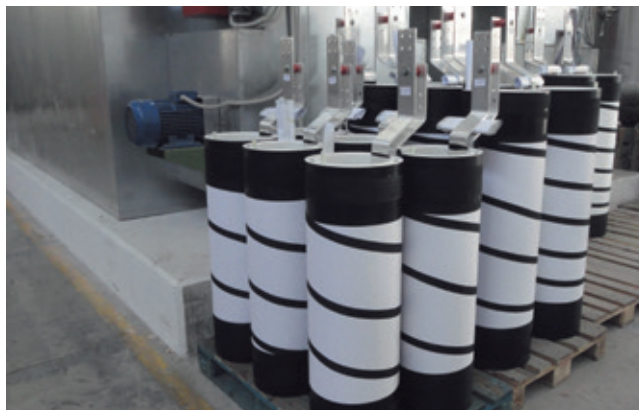
Обмотка низкого напряжения
