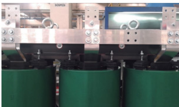
Пример выполнения выводов обмотки низкого напряжения
