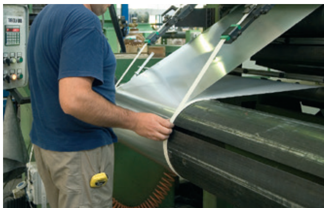
Изготовление обмотки низкого напряжения
