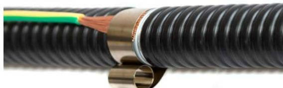
3. Прижать провод заземления одним витком пружины так, чтобы нижний край пружины находился на расстоянии не более 5 мм от среза изоляции.
