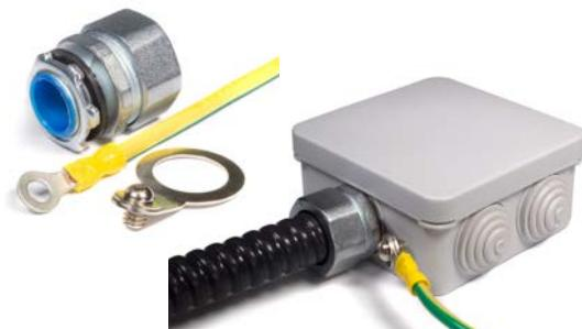
Устанавливается перед вводом металлического рукава в распределительные коробки, щиты и иные коммутационные устройства. Кольцо заземления Промрукав устанавливается на вводную муфту ВМ или ВМУ и через неё выполняет заземление металлического рукава.
