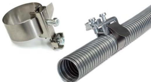
При отсутствии возможности установки заземляющего устройства на вводную муфту ВМ или ВМУ, заземление металлического рукава выполняется с помощью хомута заземления Промрукав. Это устройство заземления возможно установить в любом наиболее удобном месте. Хомут устанавливается на металлический рукав и с помощью винтового зажима, зажимается на нем.
