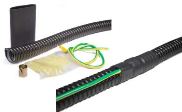
В случаях использования металлического рукава в ПВХ-изоляции и невозможностью установить заземляющее устройство на вводную муфту ВМ или ВМУ, для сохранения степени защиты IP необходимо использовать термоусаживаемую муфту заземления Промрукав.
