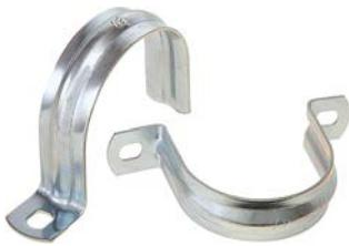
Крепёжные скобы выполнены из оцинкованной стали высокого качества. Подразделяются на «однолапковые» (СМО) и «двухлапковые» (СМД). Предназначены для крепления металлорукава и труб к различным поверхностям, а также для монтажа кабеля и провода. Ребро жёсткости, проходящее по арочному изгибу скобы, существенно увеличивает допустимые нагрузки. Пазы под крепёжный винт продольной конфигурации предполагают возможность смещения скобы без полного демонтажа.
