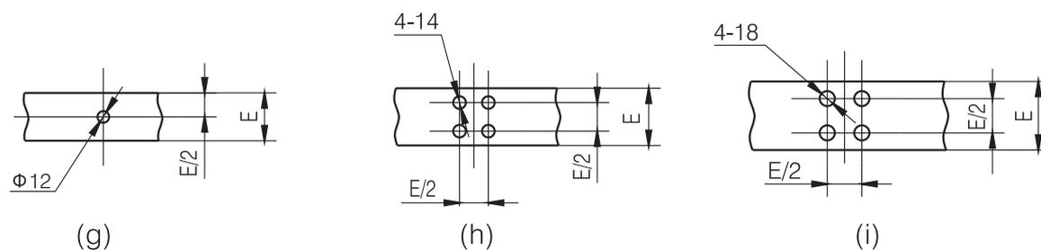
**Примечание.** Ширина шины  $E$  в точке подключения нейтрали эквивалентна ширине соединительной шины фаз а/б/с стороны НН.
