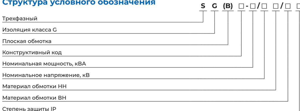
**Пример записи:** SGB10 2000/10 Cu/Cu IP31 – силовой сухой трансформатор серии SGB с воздушно-барьерной изоляцией класса Н, на номинальное напряжение 12 кВ, мощностью 2000 кВА, материал обмоток высокого и низкого напряжения из меди, степень защиты IP31 в защитном кожухе.
