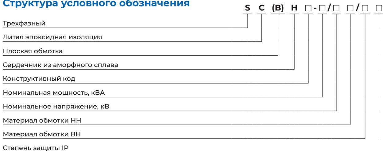
**Пример записи:** SCBH15-1600/10 CU/CU IP00 – силовой сухой трансформатор с сердечником из аморфного сплава серии SCBH15, на номинальное напряжение 12 кВ, мощностью 1600 кВА, со степенью защиты IP00, с внешней и внутренней обмотками из меди
